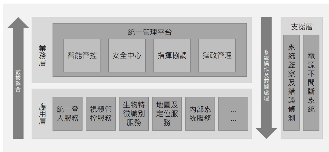
圖 2 監獄運作系統架構圖
